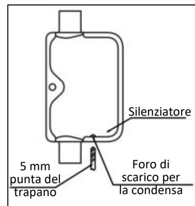
Fig. 10b - Foro di scarico per la condensa con montaggio verticale
